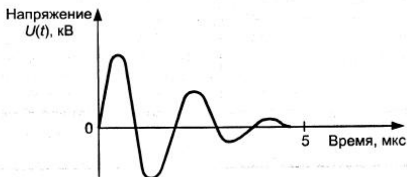
Рисунок С.4 – Форма сигнала при закороченных ограничителе помех и изоляции.
